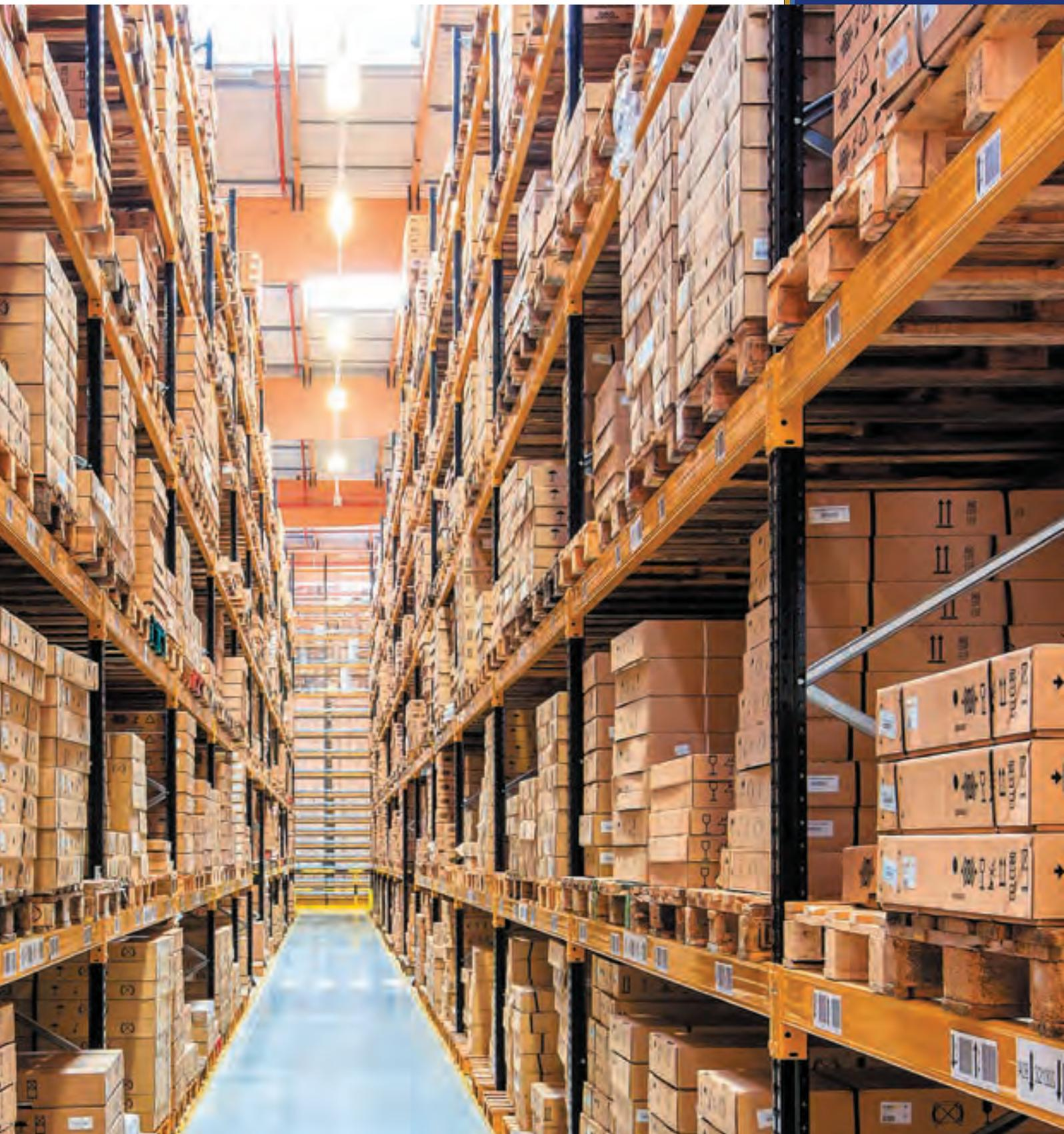
Les types d'engins de manutention utilisés déterminent la conception de l'entrepôt. **Dans le cas de charges manutentionnées au moyen d'un transtockeur**, il est généralement nécessaire de prévoir des rayonnages **de grande hauteur à allées étroites**.
