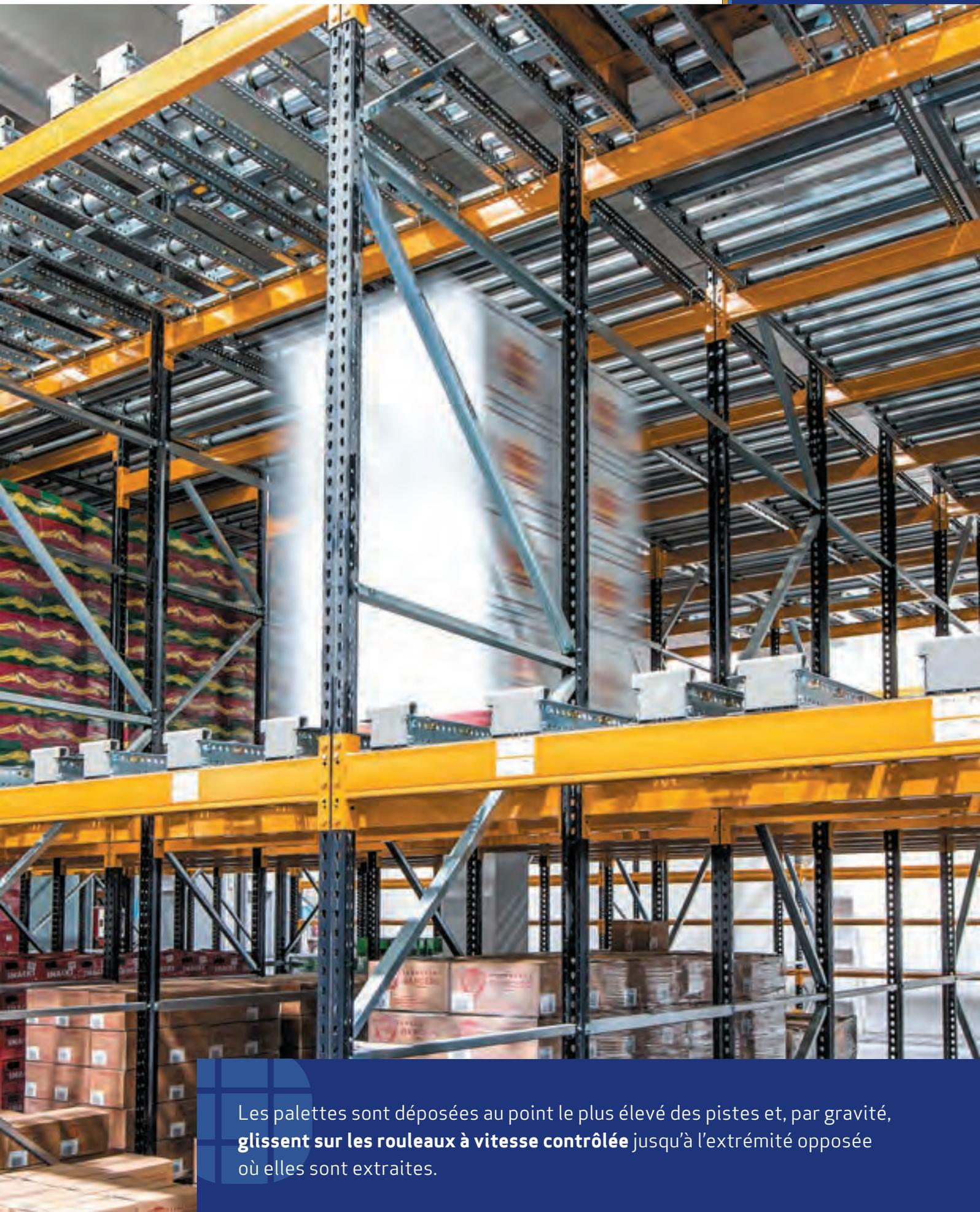
Les palettes sont déposées au point le plus élevé des pistes et, par gravité, **glissent sur les rouleaux à vitesse contrôlée** jusqu'à l'extrémité opposée où elles sont extraites.
