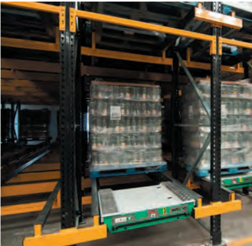
La navette satellite ou «shuttle» est **une base dont le déplacement est actionné depuis une commande électrique externe.**
