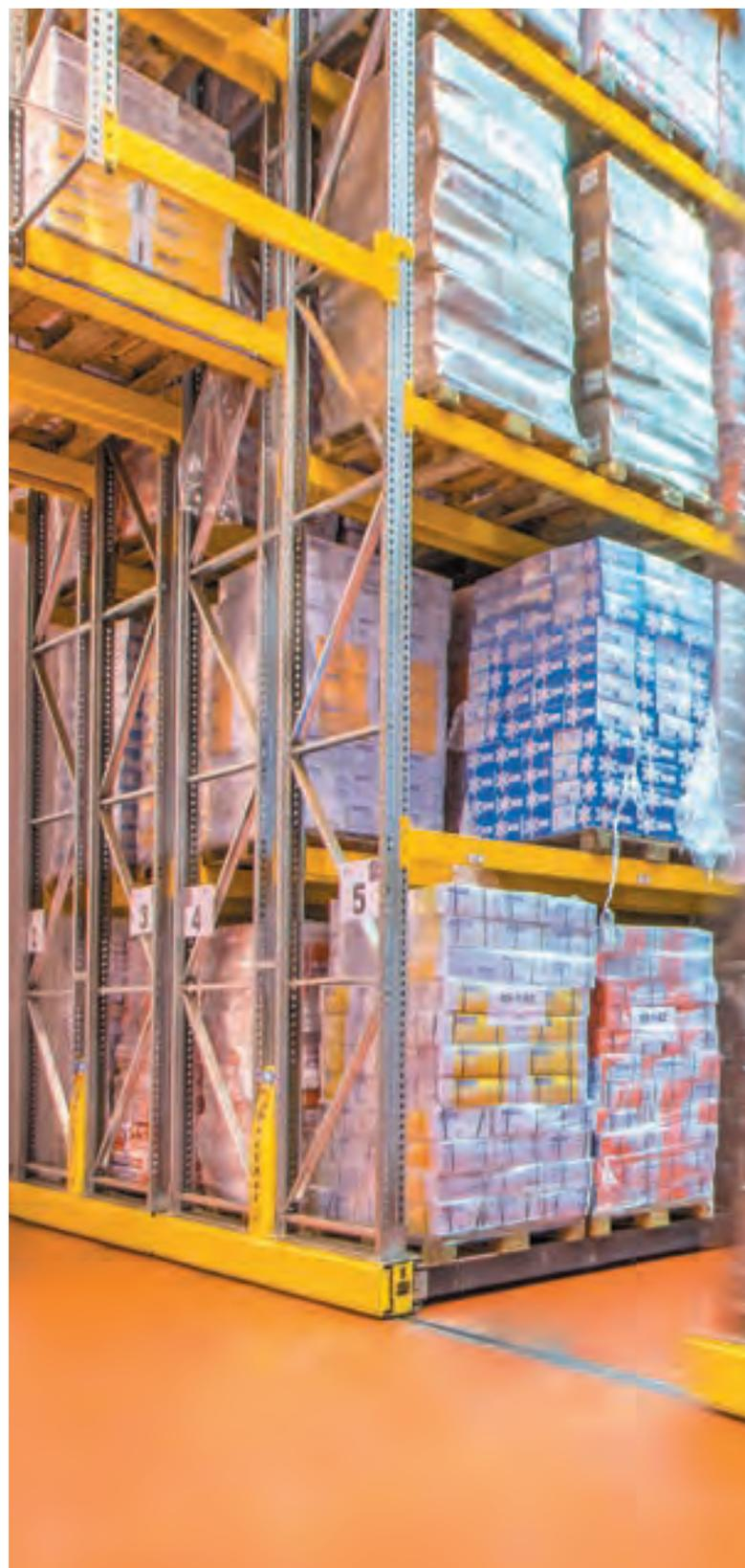
Les bases mobiles sont constituées d'un châssis à roues (motorisé ou non) et de **lisses laminées à chaud, hautement résistantes aux chocs.**
