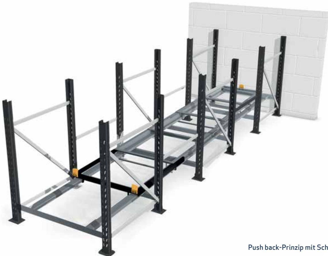
Push back-Prinzip mit Schlittensystem
