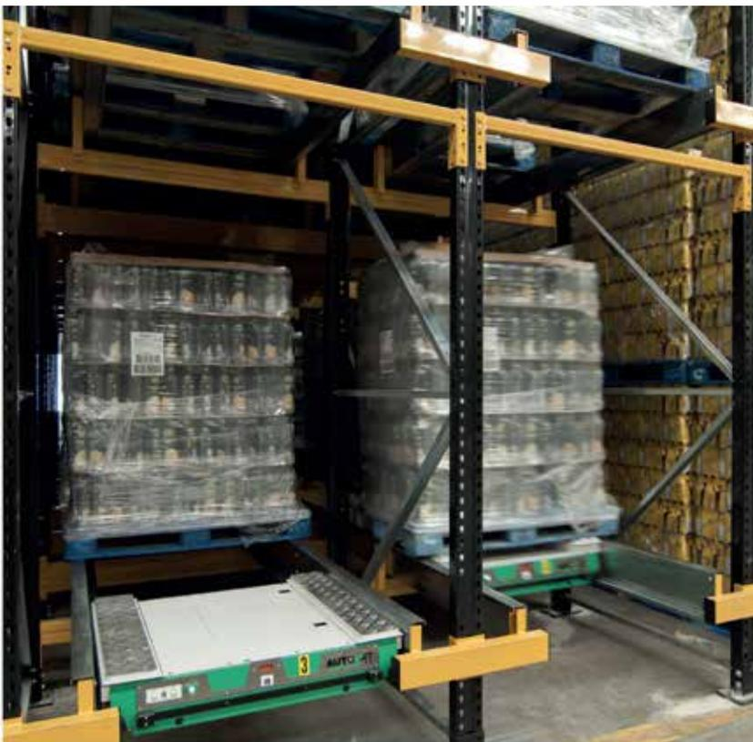
Ein Satellitenfahrzeug oder Shuttle ist ein elektrisch angetriebenes Kanalfahrzeug, das automatisch mittels einer Steuereinheit von außerhalb des Regalsystems bedient wird.
