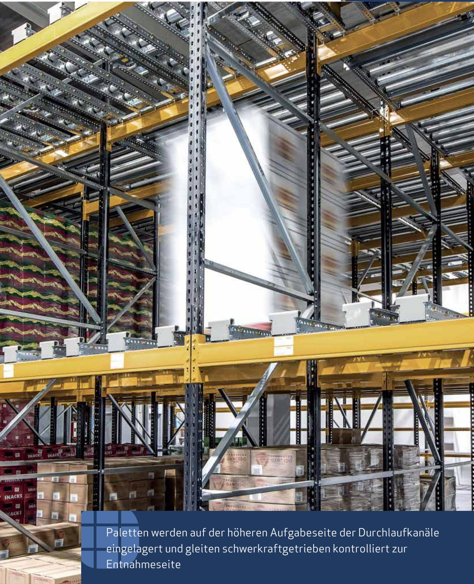
Paletten werden auf der höheren Aufgabeseite der Durchlaufkanäle eingelagert und gleiten schwerkraftgetrieben kontrolliert zur Entnahmeseite
