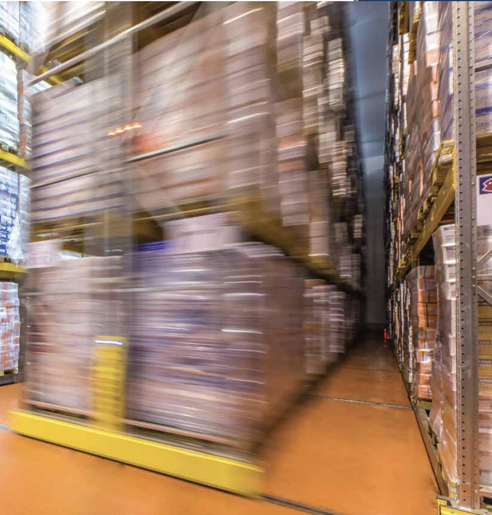
Die Verfahrrégalanlage wird mit aktiven und passiven Sicherheitssystemen ausgestattet. Lichtschranken in Längsrichtung der Verfahrwagen für die Absicherung des einzelnen Arbeitsganges. Frontlichtschranken in Querrichtung zur Zugangsabsicherung für die kompletten Arbeitsgänge der Anlage.
