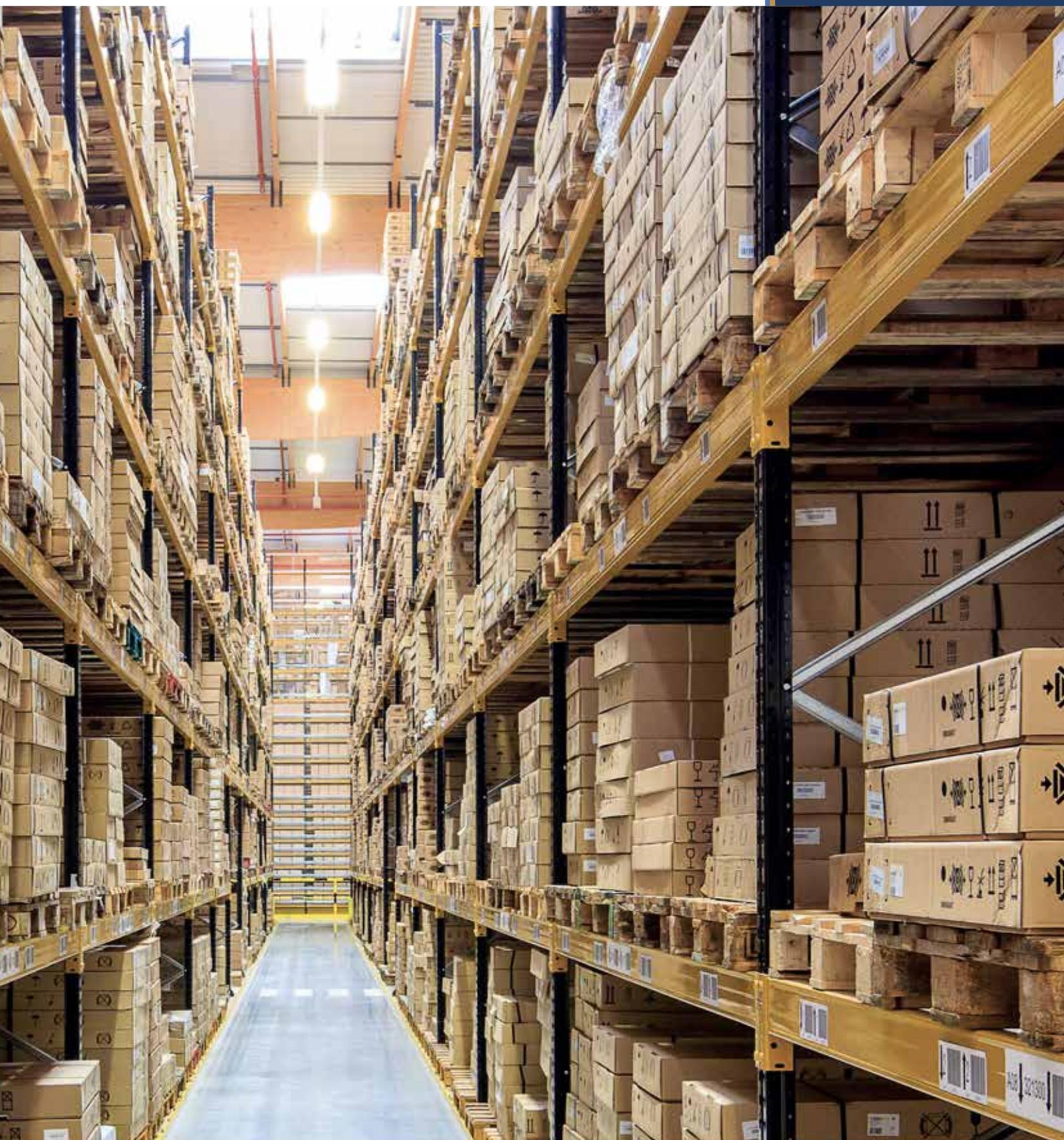
Die eingesetzte Staplertechnologie bestimmt die Gestaltung des Palettenlagers. Insbesondere sehr hohe Räume erreichen mit Schmalganglagern einen hervorragenden Raumnutzungsgrad.
